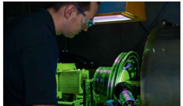
N3 Engine Overhaul Services verfügt über modernste Anlagentechnik für die zerstörungsfreie Werkstoffprüfung von Triebwerkteilen. Damit können die am häufigsten geforderten Prüfverfahren in der Luftfahrt mit hoher Prozesssicherheit und Rückverfolgbarkeit angewendet werden. Alle prüfberechtigten Mitarbeiter sind nach DIN EN 4179 / NAS 410 Level 1 bzw. Level 2 qualifiziert. Die Koordination und Überwachung der Prozesse wird durch die Level-3-Aufsichtsperson sichergestellt.
